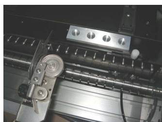
フラックス供給装置とボール受け皿
